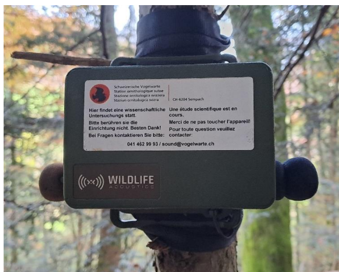
Fig. 14 Positionnement et fixation des enregistreurs acoustiques SM Mini. © Tatiana Kornienko.
