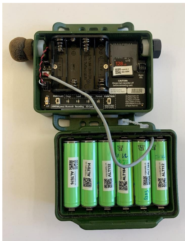
Fig. 42 Wildlife Acoustics Song Meter Mini supplémenté d'une batterie Lithium-ion externe, © Sabrina Clément
